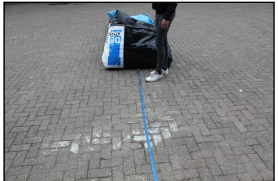
Stap 10: Til de achterkant van het luchtkussen op en plaats een spanband tegen het luchtkussen aan.
