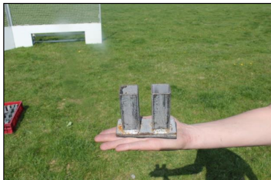
Stap 15: Tussen paneel 8 en 9 komt een verbindingshouder zoals op foto.
