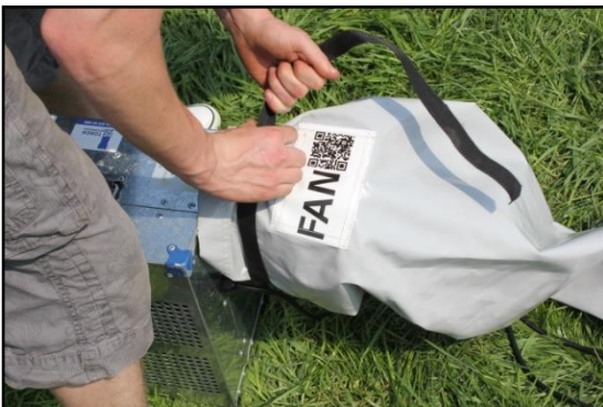
Stap 11: Sluit de blower aan op de luchtslang.
