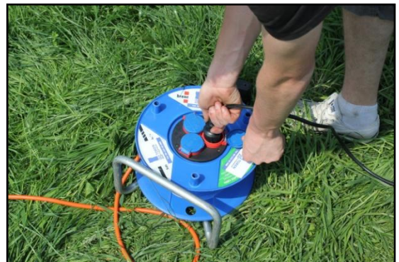
Stap 12: Steek de stekker in de gearde en afgerolde haspel.
