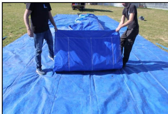
Stap 18: Rol het luchtkussen op van af einde. Met het rolsysteem.
