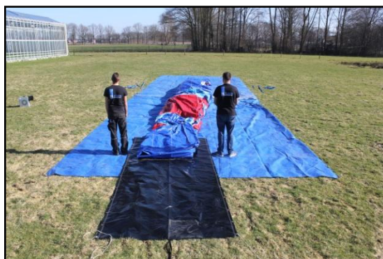
Stap 16: Plaats het transportzeil op de spanband tegen het luchtkussen aan.
