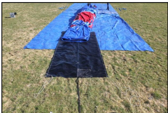
Stap 17: Plaats het luchtkussen op het transportzeil.
