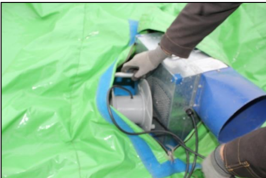
Stap 9: Plaats het haspel in het maangat tegen de roosterkant van de blower.
