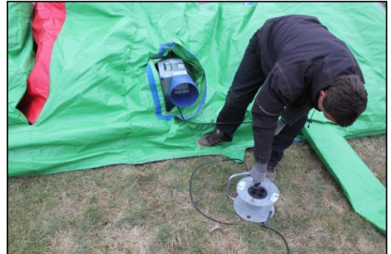
Stap 8: Stop de stekker in het gearde haspel.
