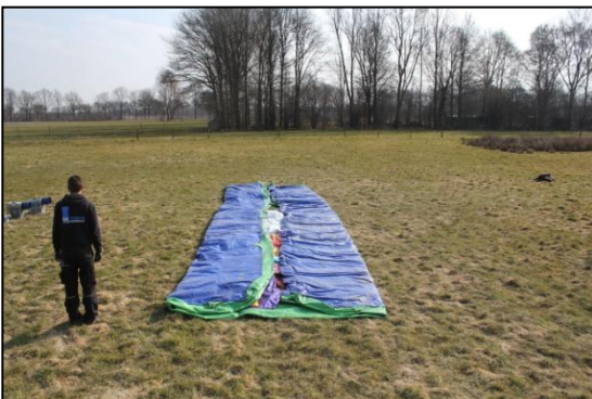
Stap 17: Vouw/trek het luchtkussen links naar rechts een rechte baan van 110-130 cm zodat de 2 delen tegen elkaar aan liggen.
