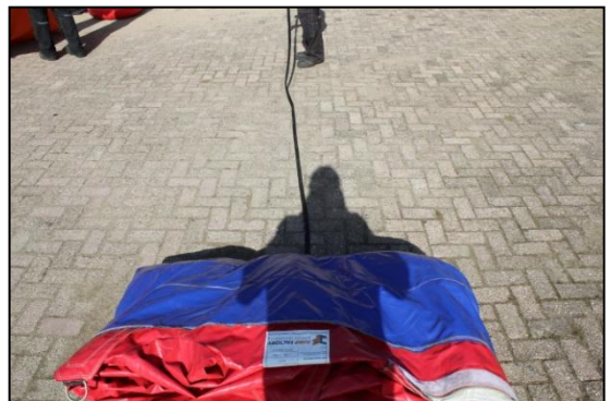
Stap 12: Til het luchtkussen aan de achterkant op en plaats een spanband tegen het luchtkussen.
