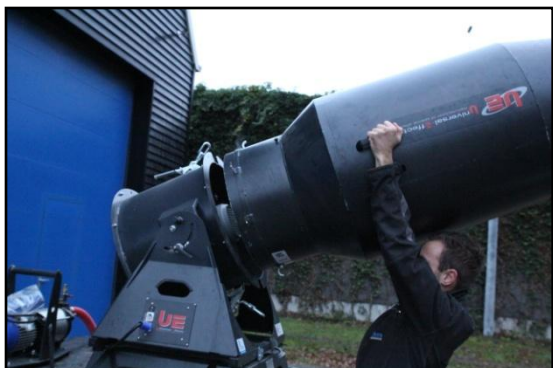
Stap 7: Til het kanon van de ventilator
