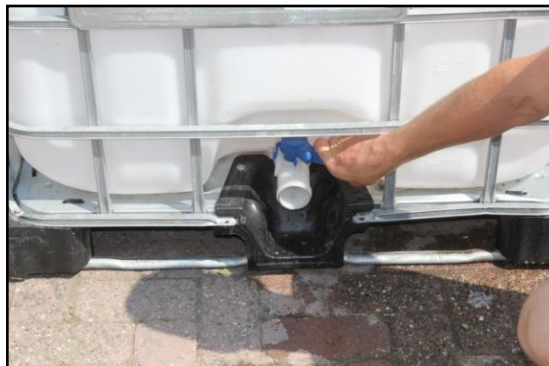
Stap 2: Zet de kraan open aan de onderkant van het vat als er nog vloeistof in zit.
