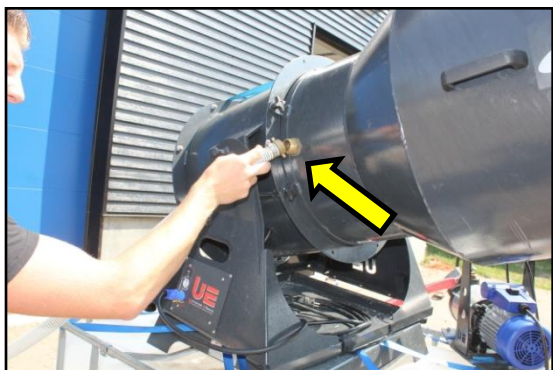
Stap 5: Draai de (witte) slang los aan het kanon
