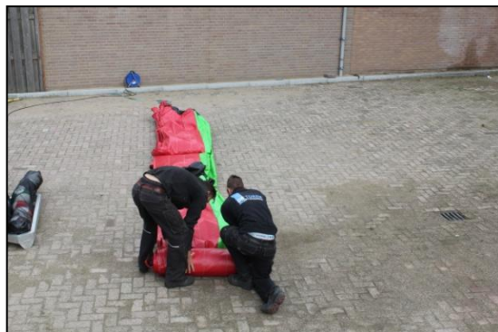
Stap 10: Rol het luchtkussen zo strak mogelijk op richting de spanband.
