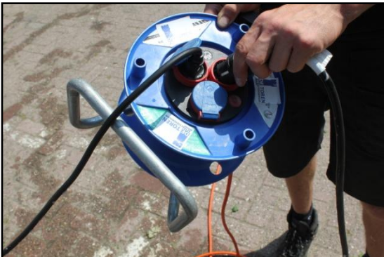
Stap 3: Verwijder de stekkers uit het stopcontact.
