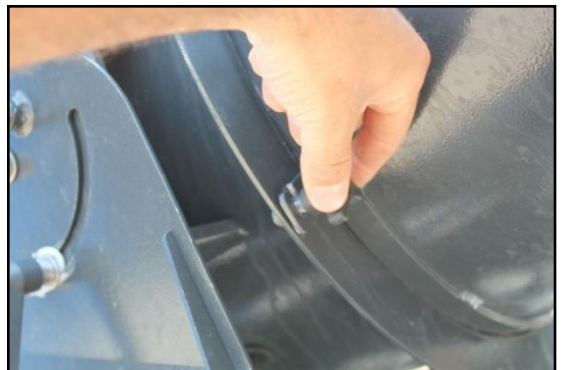
Stap 6: Draai de draaiknoppen die het kanon en de ventilator aan elkaar verbinden alle 4 een paar slagen los.
