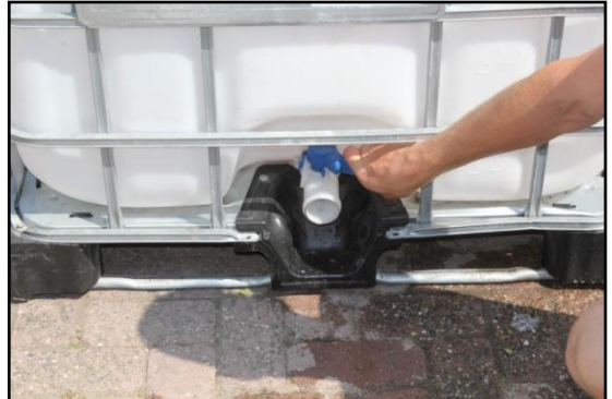
Stap 2: Zet de kraan open aan de onderkant van het vat als er nog vloeistof in zit.
